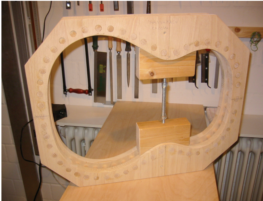
Bild 7: Zargenform mit Spannvorrichtung
