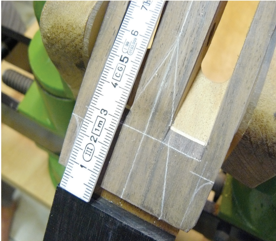
Bild 4: Abschrägung für den Saitenlauf
