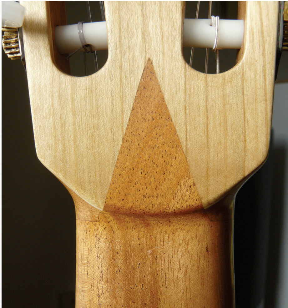
Bild 3 : Übergang Halsprofil zur Kopfplatte
