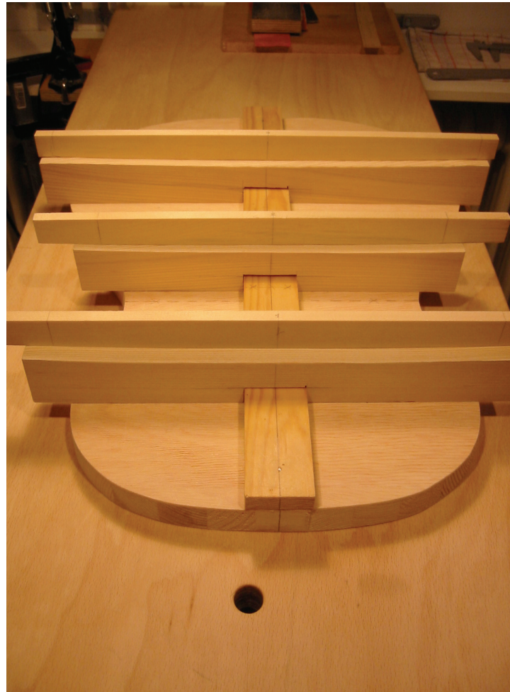
Bild 8 : Arbeitsbrett für die Bodenbeleistung (fertig profilierte Leisten sind eingelegt)
