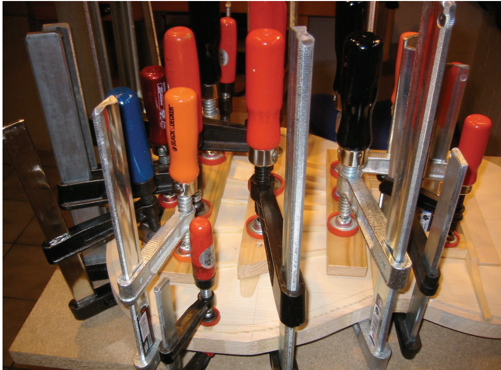
Bild 14 : Verleimung von Unterfutter, Fächerleisten, Stützklötzchen und Schallochverstärkungen
