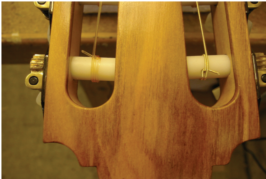
Bild 29: Befestigung der Saiten auf der Welle
