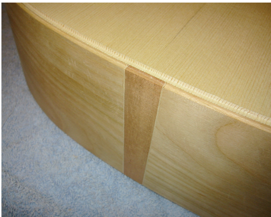
Bild 19 : fertiger Falz an der Decke (der Zwickel ist eingesetzt)
