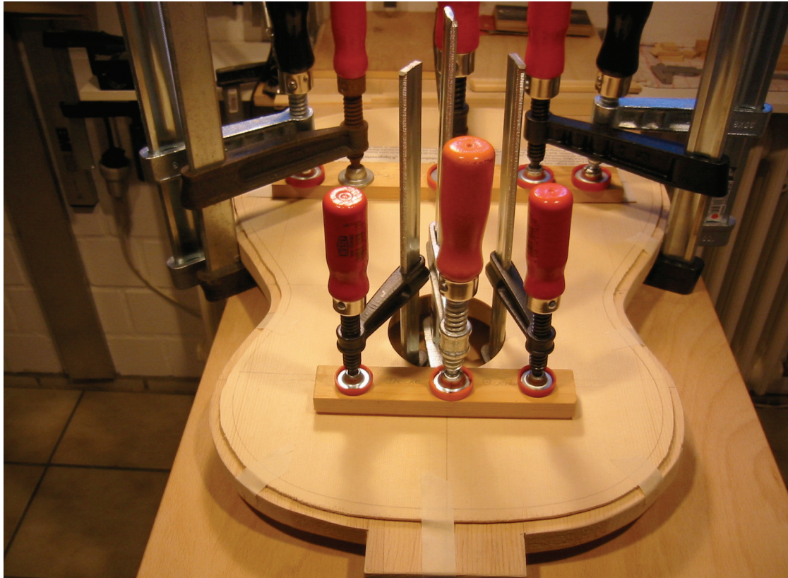
Bild 12: Verleimung von Oberfutter und Stegfutter
