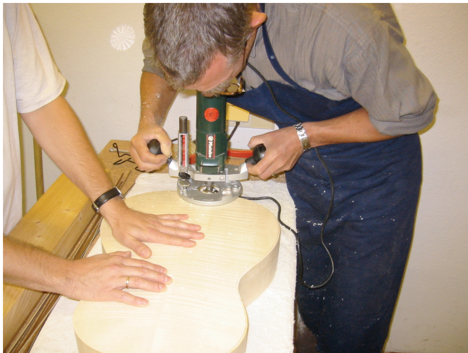
Bild 18 : Einfräsen des Falzes
