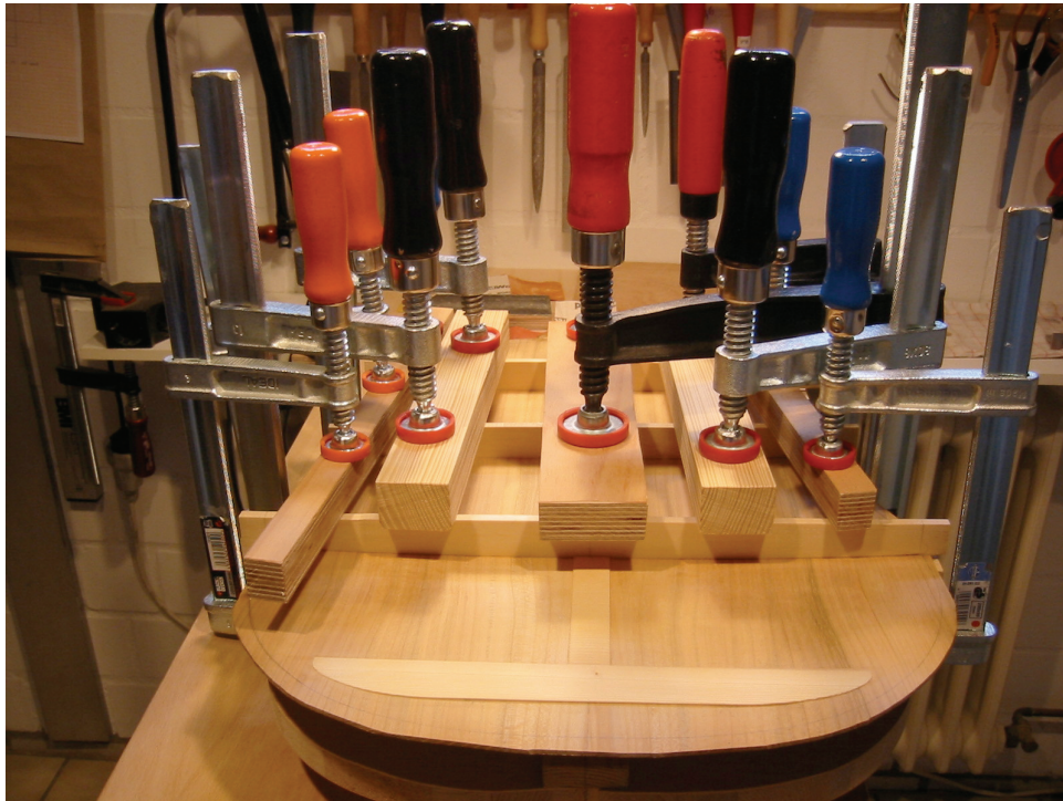
Bild 10 : Verleimung der Bodenbalken
