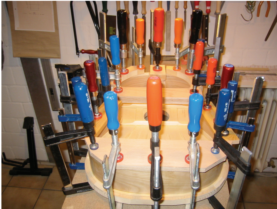
Bild 16: Verleimung der Decke mit dem Zargenkranz
