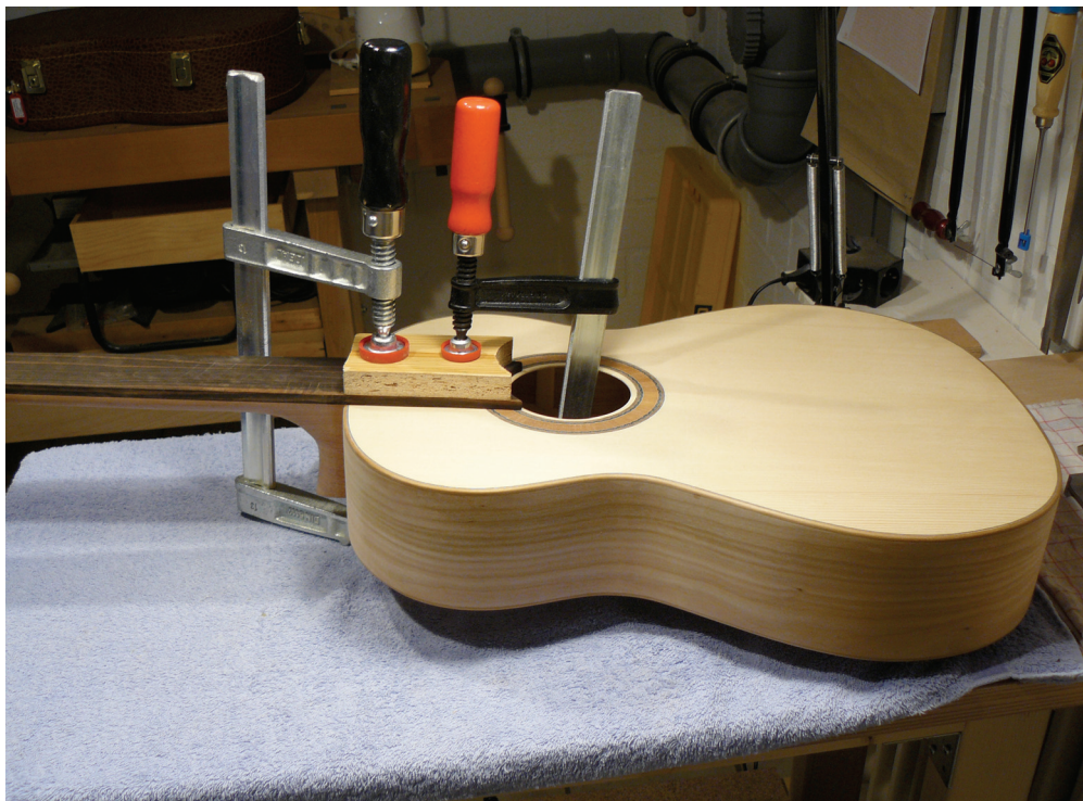
Bild 25. Verleimung des Halses
