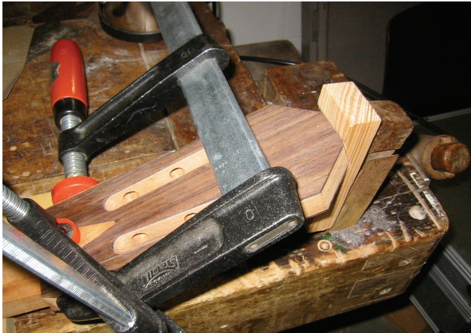
Bild 1 : Dreipunktverleimung von Hals-Kopfplatte mit verdecktem Schwalbenschwanz
